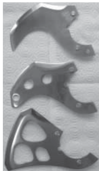
Abb. 1: Verwendete Messer (Standardmesser (oben), Lochmesser (Mitte) und Hack-Lochmesser (unten))
