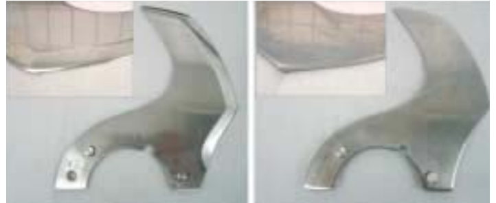
Abb. 1: Verwendete Messer (links Standardmesser, rechts Messer ohne Schneide)
