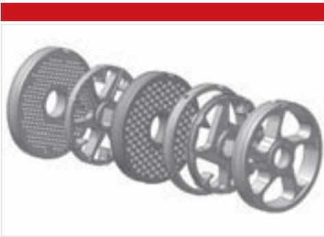
Abb. 3: Die Vorgänge der Zerkleinerung werden mit fortschreitender Schneidebene immer schneller.
