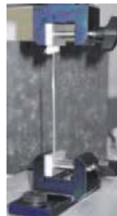
Abb. 1: Texturanalyser TA XTPlus Winopal der Firma Stable Micro Systems mit dem Zugwerkzeug A/TG Tenside Grips, Zerreißvorgang eines Saitlings Fig. 1: Texture analyser TA XTPlus Winopal Stable Micro Systems with instrument for draw extension A/TG Tenside Grips, tearing process of a sheep casing
