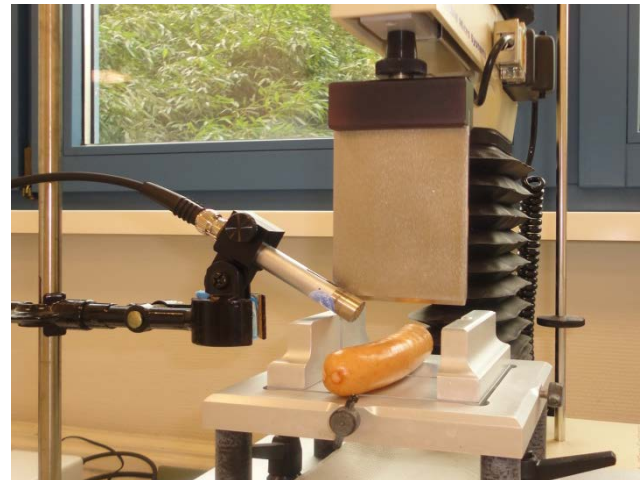
Abbildung 1: verwendete Messvorrichtung aus Texture Analyser mit Guillotine und Acoustic Detector
